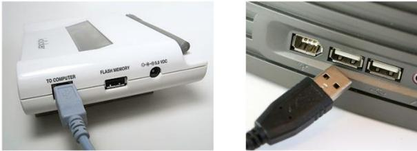
الشكل (٤) : توصيل الرسيفر بجهاز الحاسب الالى
