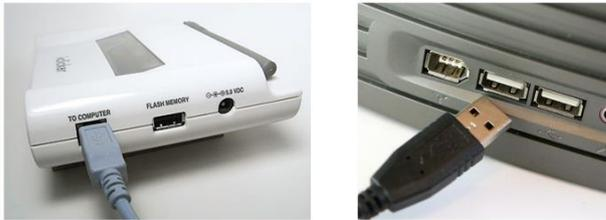
الشكل (4) : توصيل الرسيفر بجهاز الحاسب الالى
